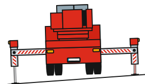
Ungünstige Position der Abstützung
